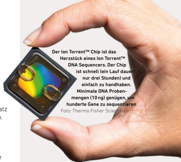
Der Ion Torrent™ Chip ist das Herzstück eines Ion Torrent™ DNA Sequencers. Der Chip ist schnell (ein Lauf dauert nur drei Stunden) und einfach zu handhaben. Minimale DNA Probenmengen (10 ng) genügen, um hunderte Gene zu sequenzieren
